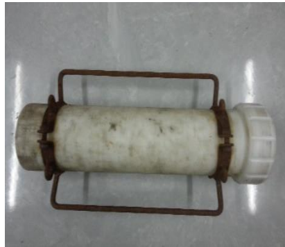
Şekil 3.6. Kamera Kap Sisteminin üstten ve yandan görüşleri
