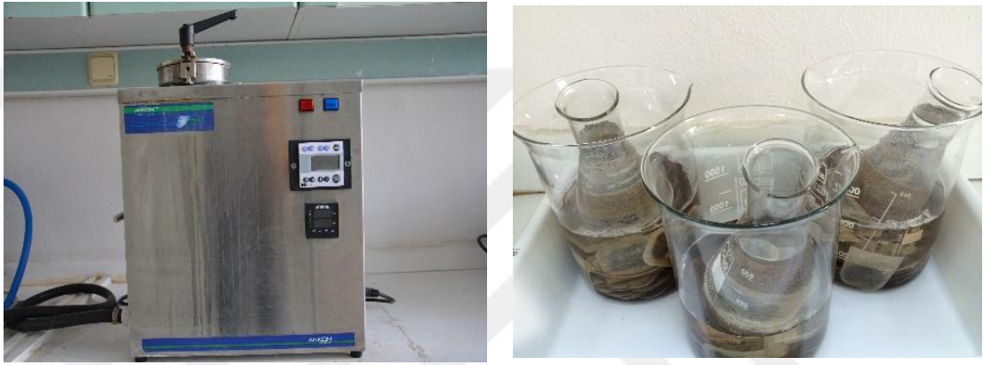
Şekil 3.10. Ankom filter bag tekniği ile dallı darı biyokütlesi lignoselülozik yapısının tayini
