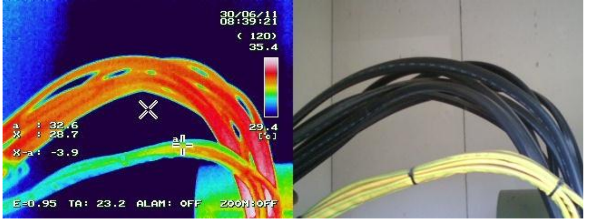
Şekil 3.8. Kablolarda indüksiyon ısınması termal görüntü (Anonymous, 2014-f)
