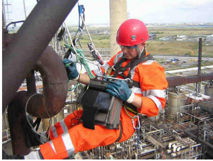
Şekil 3.10. Ultrason ile kaçak tespiti (Anonymous, 2014-c)
