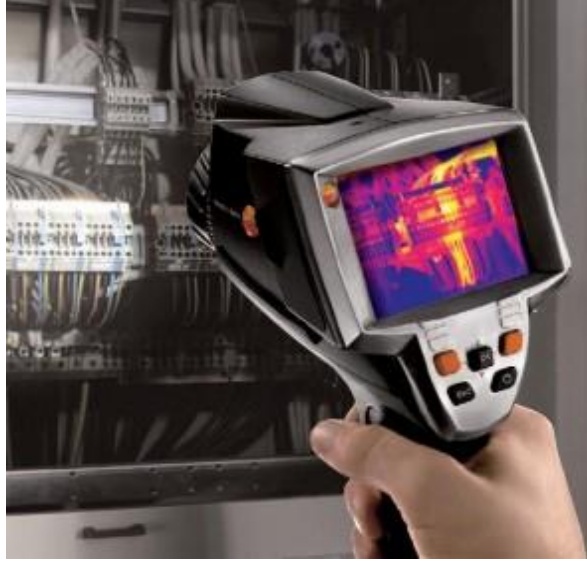
Şekil 3.3. Termal kamera ile görüntü alma (Anonim, 2014-g)
