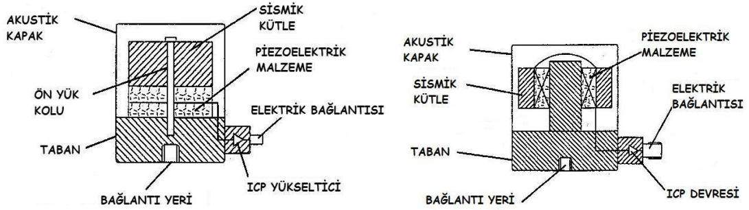
Şekil 3.21. Baskı tipi ve kesme tipi ivme sensörleri (Denli, 2007)
