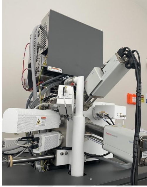
Şekil 3. 6. Örneklerin yüzey görüntülerinin alındığı ve elementel analizlerin yapıldığı cihaz, Thermo Fisher Scientific Apreo S taramalı elektron mikroskobu.
