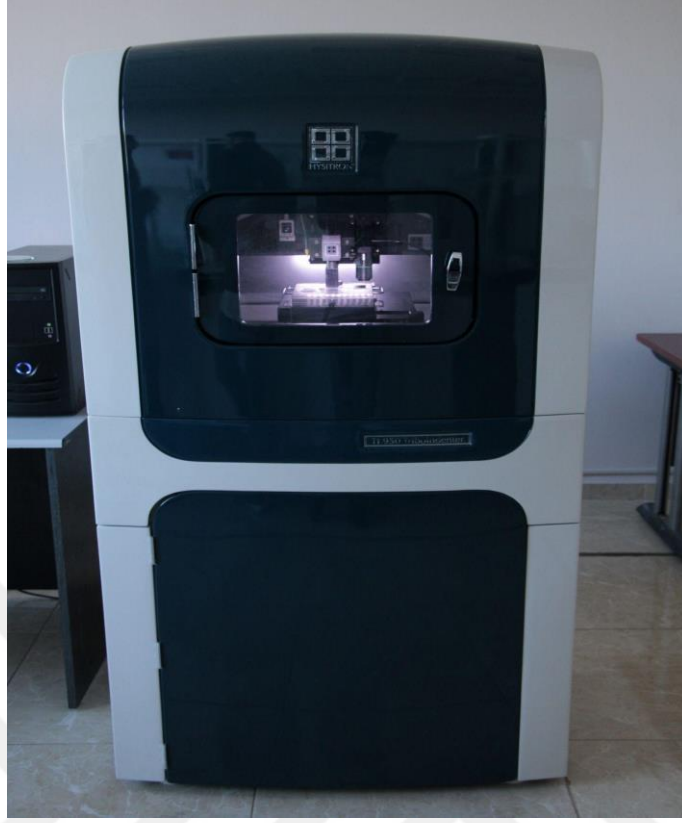
Şekil 3. 5. Nanosertlik, elastisite modülü ve yüzey pürüzlülüğü analizlerinin yapıldığı cihaz, Hysitron TI 950 TriboIndenter (Hysitron, ABD)
