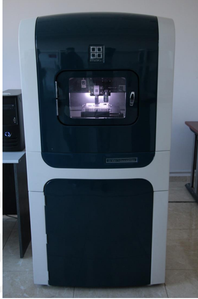
Şekil 3.8. Hysitron TI 950 TriboIndenter nanoindentasyon cihazı (Hysitron, ABD)
