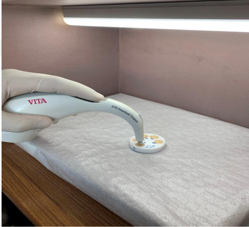
Şekil 3.13. Spektrofotometre İle Renk Değerlerinin Tespiti
