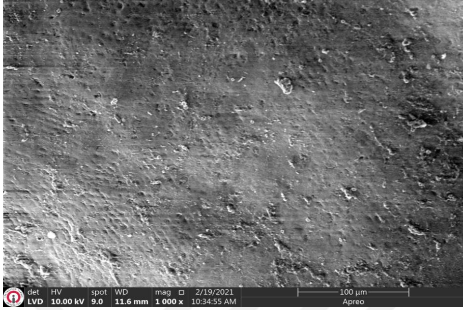
Şekil 4.18. G5 örneğinin Opalescence® PF %10 uygulandıktan sonraki x1000 SEM görüntüsü
