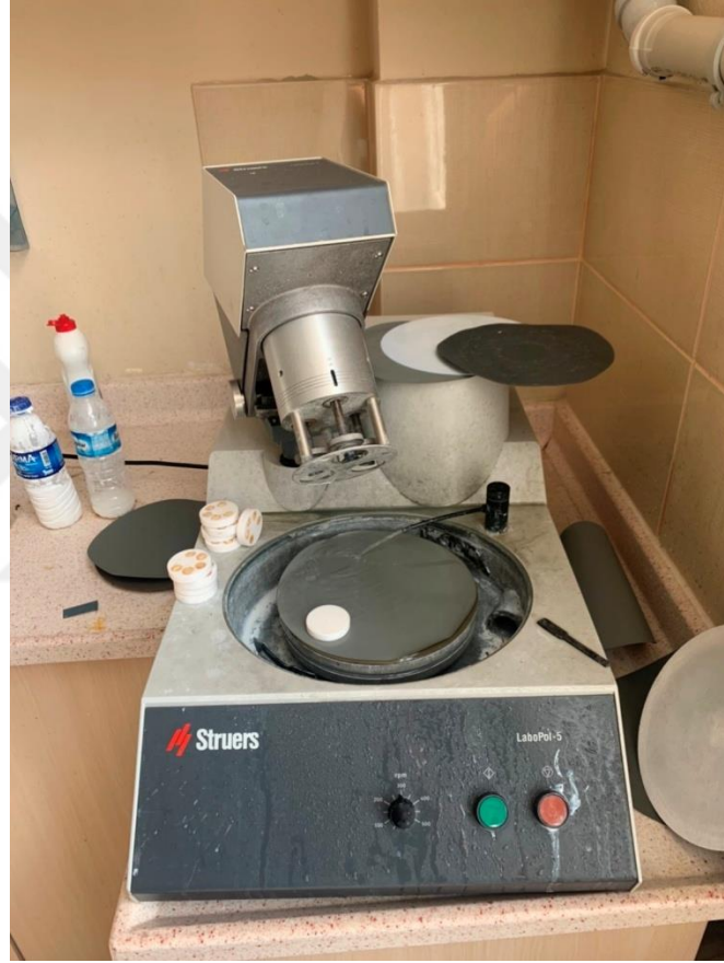
Şekil 3.10. Nanoindenter İncelemesi İçin Örneklerin Zımparalanması
