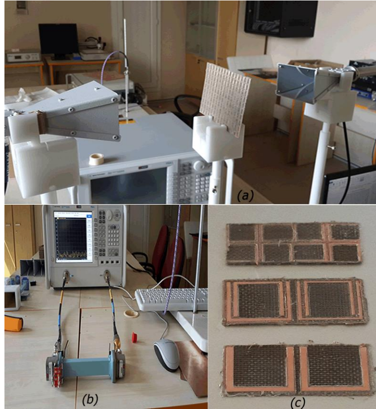
Şekil 4.14 Deneysel kurulum şeması (a) periyodik birim hücre, (b) dalga kılavuzu ölçümleri, (c) Dalga kılavuzu ölçümleri için üretilen U-şekilli FSY numuneleri
