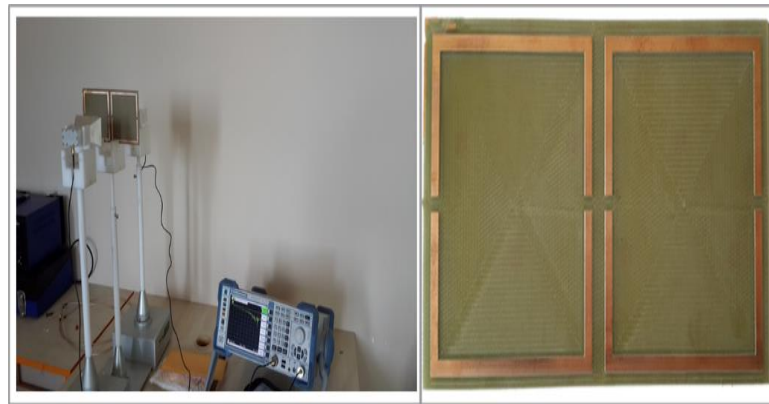
Şekil 4.92 Metamalzeme sinyal emici tabanlı kablosuz enerji transferi uygulaması için önerilen yapının sadece metamalzeme sinyal emici olarak uygulaması için üretilen yapı ve bu yapının laboratuvar ortamındaki test görüntüsü
