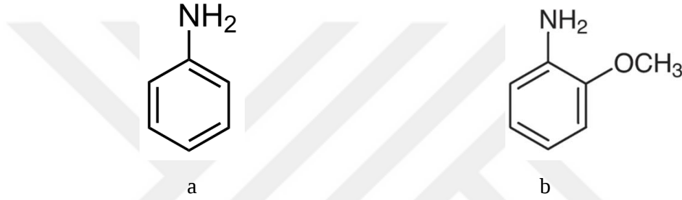
Şekil 1.2. Anilin (a) ve o -anisidin (b) monomerlerinin kimyasal yapıları
