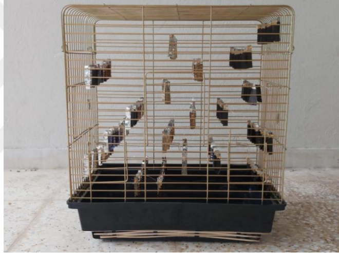
Şekil 3.2. Kuponların denizde inkübasyonu için kullanılan kafes sistemi
