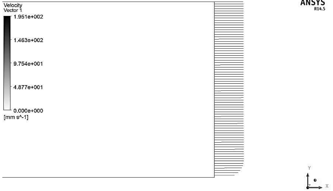
Şekil 4.55. Standart k-\omega çalıştırılan boş kanalda hız profili ( Re_d=9600 )
