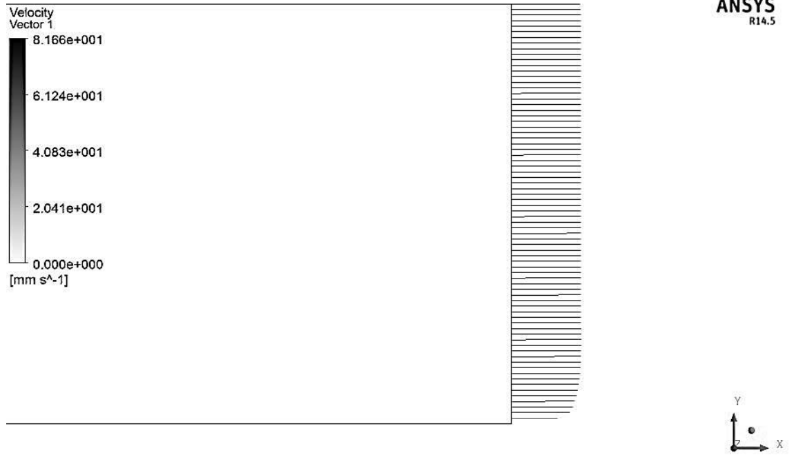
Şekil 4.39. Standart k-\varepsilon çalıştırılan boş kanalda hız profili ( Re_d=4000 )
