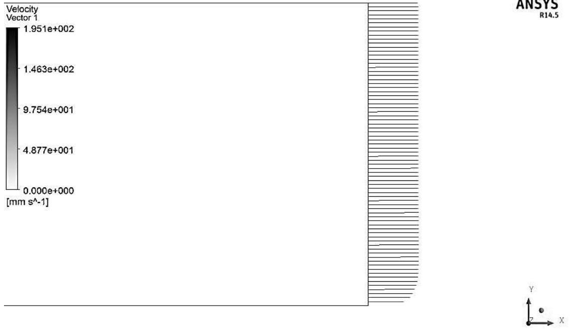
Şekil 4.53. Realizable k-\varepsilon çalıştırılan boş kanalda hız profili ( Re_d=9600 )
