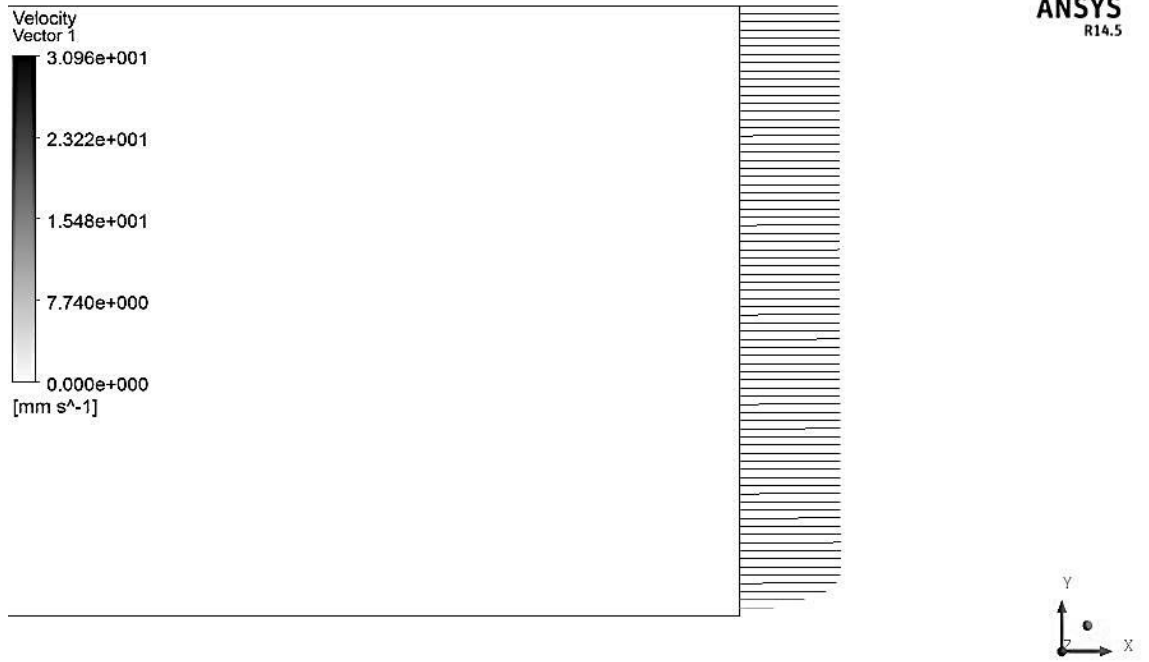
Şekil 4.27. Laminar çalıştırılan boş kanalda hız profili ( Re_d=1500 )
