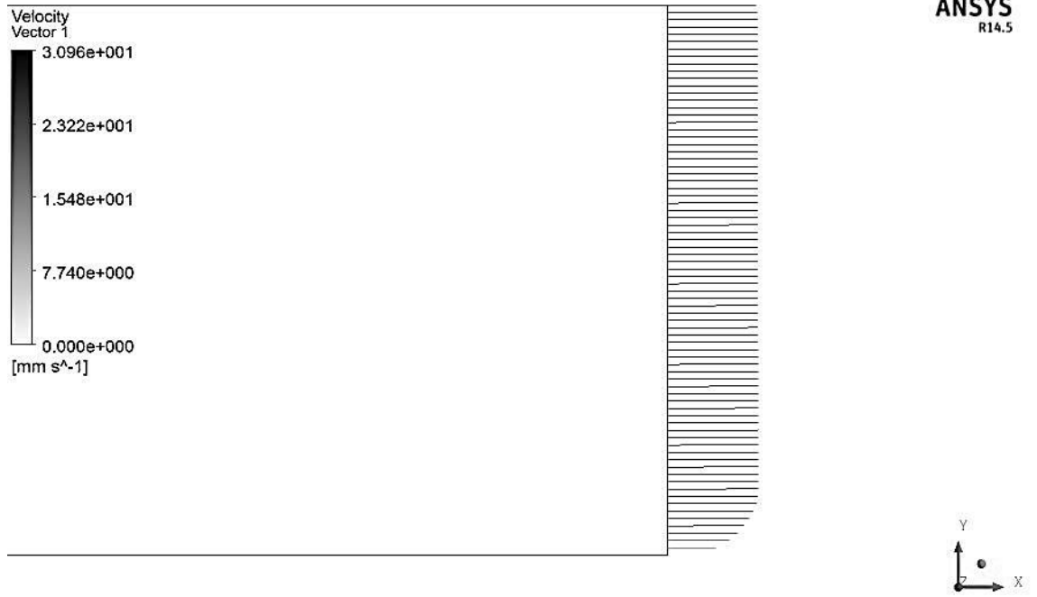
Şekil 4.33. Realizable k-\varepsilon çalıştırılan boş kanalda hız profili ( Re_d=1500 )
