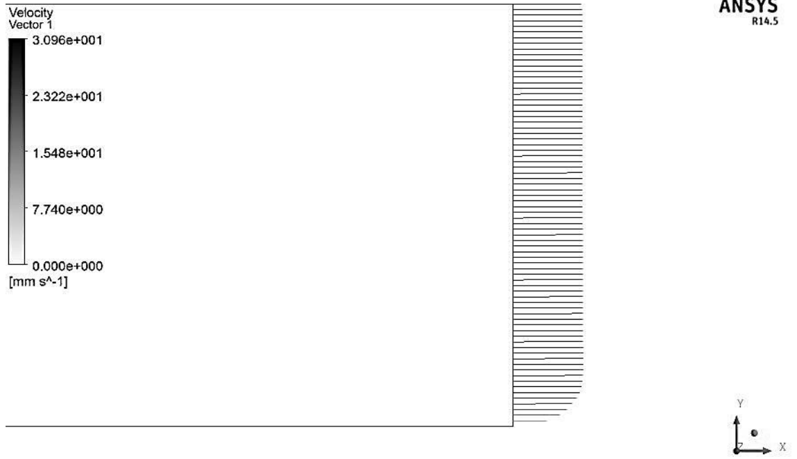
Şekil 4.37. Sst k-\omega çalıştırılan boş kanalda hız profili ( Re_d=1500 )
