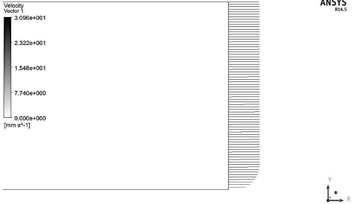
Şekil 4.29. Standart k - \epsilon çalıştırılan boş kanalda hız profili ( Re_d=1500 )
