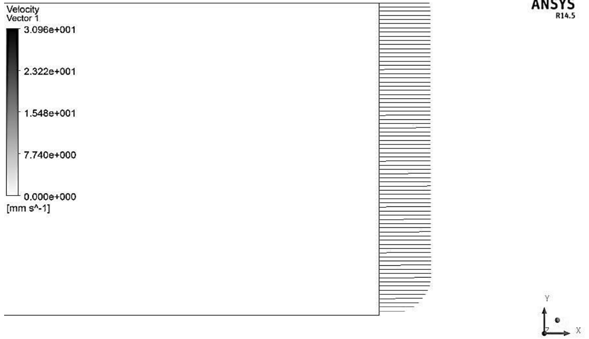
Şekil 4.35. Standart k-\omega çalıştırılan boş kanalda hız profili ( Re_d=1500 )
