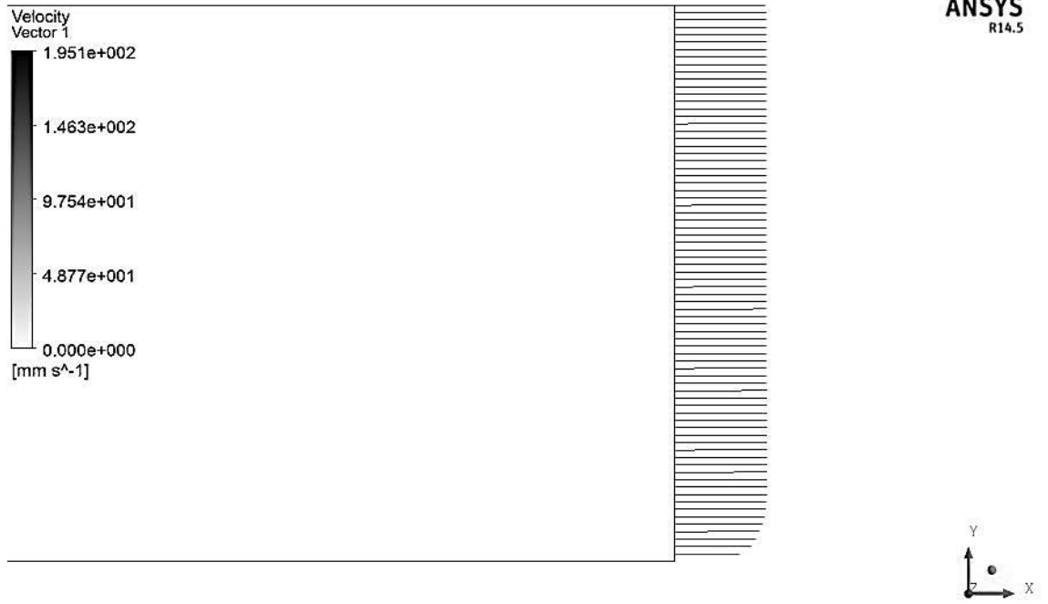
Şekil 4.49. Standart k-\varepsilon çalıştırılan boş kanalda hız profili ( Re_d=9600 )
