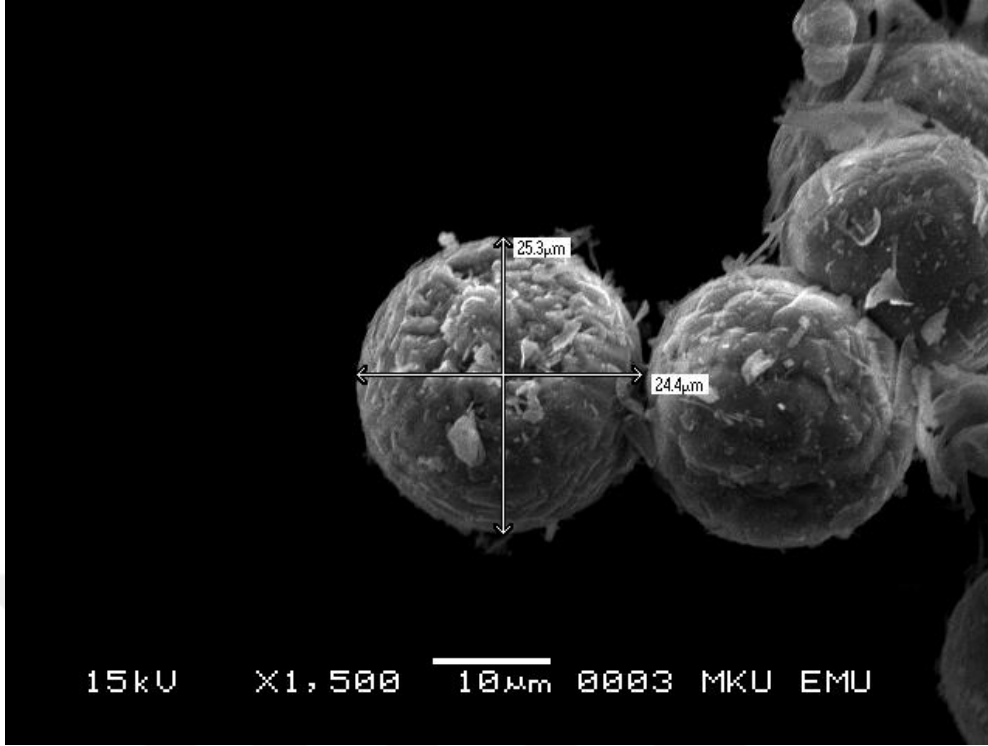
Şekil 4.4. Sentetik analsim zeolitinin SEM görüntüsü ve tanecik çapı
