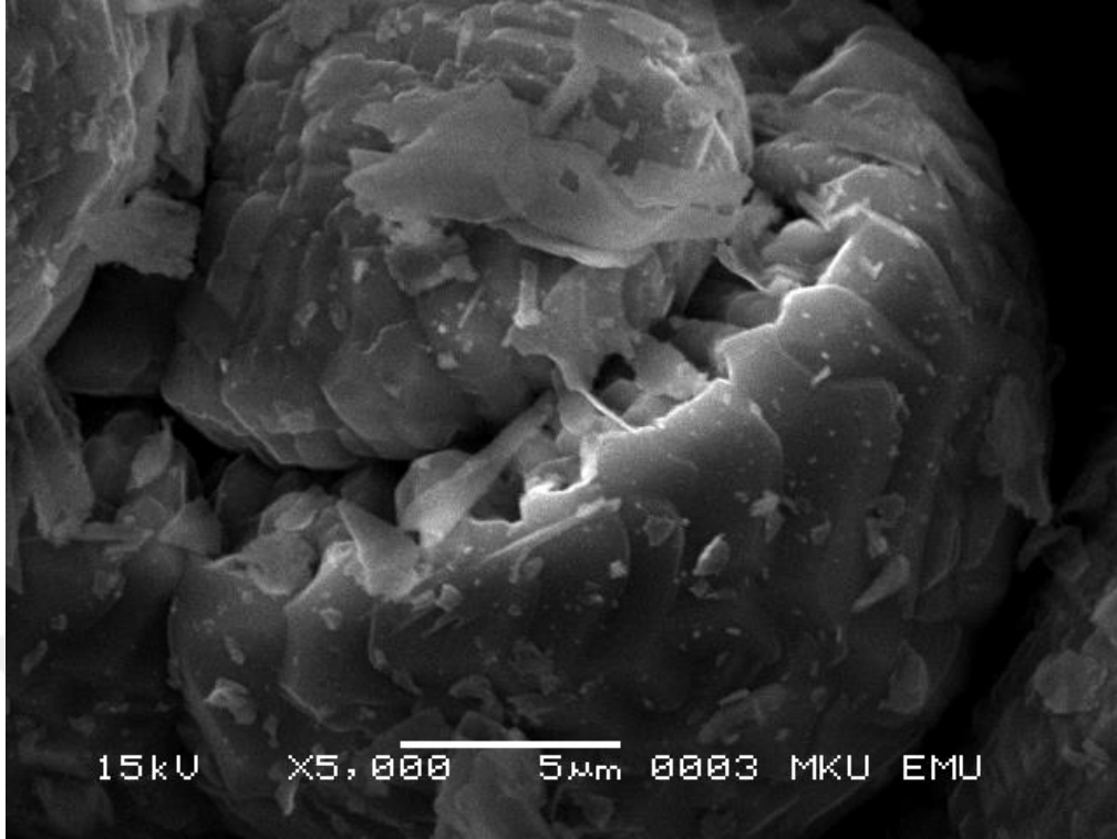
Şekil 4.5. Sentetik analsim kristalleri oluşumu esnasında kristal yapıları arasında oluşan düzensiz boşlukların SEM görüntüsü
