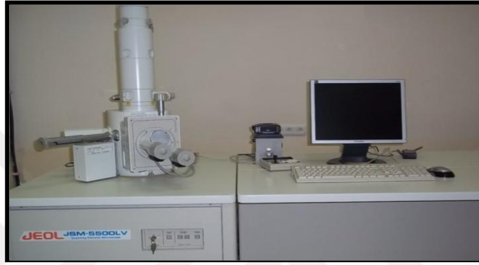
Şekil 3.18. Mustafa Kemal Üniversitesi Fen Bilimleri Araştırma ve Uygulama Merkezinde bulunan Jeol marka JSM-5500LV model numunelerin yüzey analizinde kullanılan Taramalı Elektron Mikroskobu (SEM)
