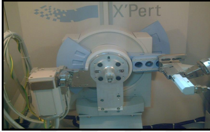
Şekil 3.17.X-ışını Difraktometresi (PhilipsX'pert Pro, Cu K \alpha , \lambda=1.540056 \text{ \AA} )
