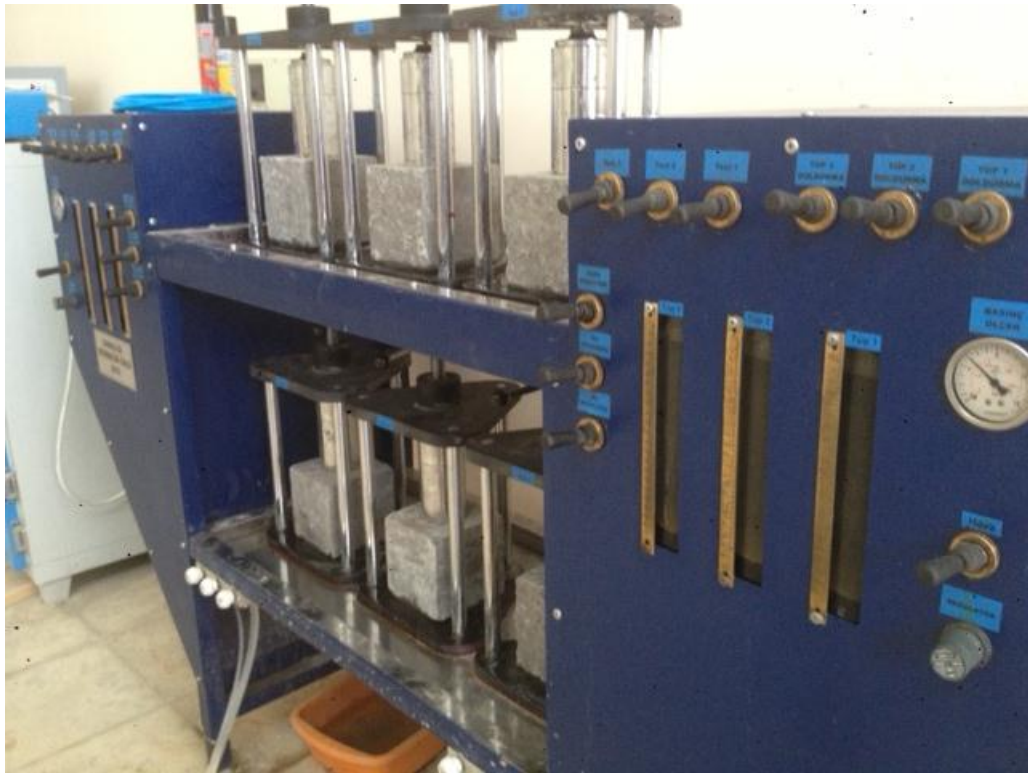
Şekil.3.9. Basıncılı su geçirgenliği deney düzeneği
