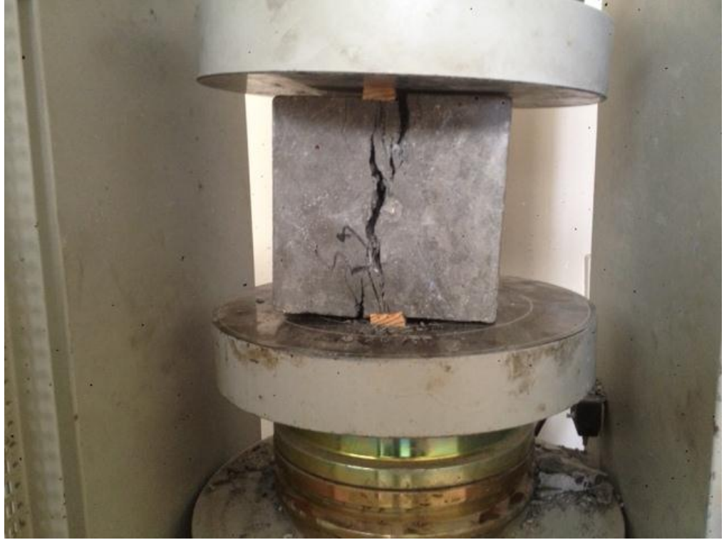
Şekil 3.12. Yarma dayanımı deney düzeneği
