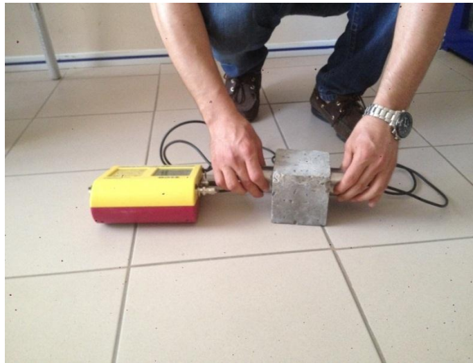
Şekil 3.8. Ultrasonik ses deneyi düzeneği
