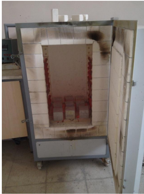
Şekil 3.6. Sıcaklık etkisi deneyi düzeneği
