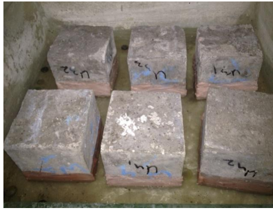
Şekil 3.5. Kapilarite katsayısı deneyi düzeneği
