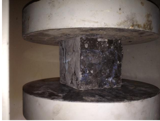
Şekil 3.2. Beton basınç deneyi düzeneği
