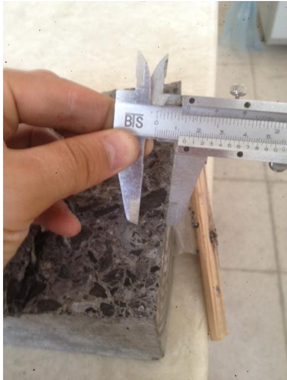
Şekil 3.10. Basınçlı su geçirgenliği deneyi su işleme derinliği ölçümü
