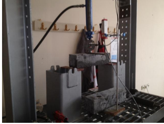
Şekil 3.4. Eğilme dayanımı deneyi düzeneği
