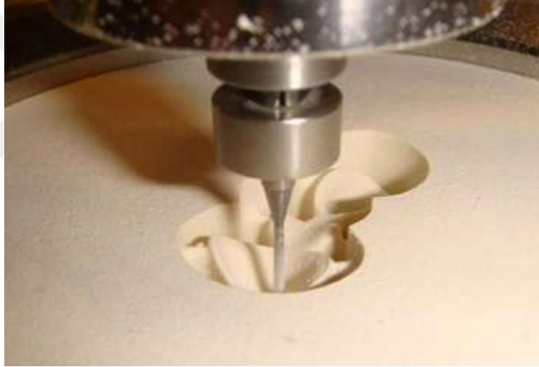
Resim 6: CAD yazılımında tasarlanan altyapının CAM sisteminde eksiltme yöntemi ile üretilmesi
