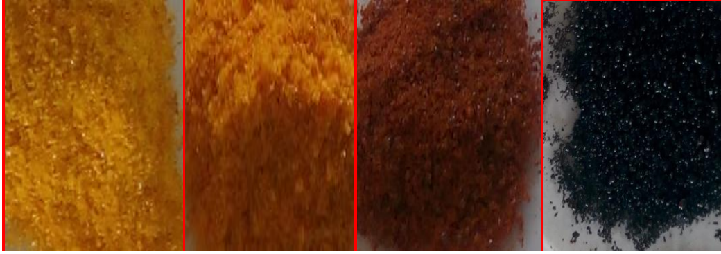
Ek 48. L^3B 'nin ısıı davranışı (ısıı görmemiş, 120 ^{\circ}C , 180 ^{\circ}C , 230 ^{\circ}C )
