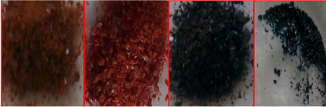
Ek 48. L^3B 'nin ısıı davranışı (ısıı görmemiş, 120 ^{\circ}C , 180 ^{\circ}C , 230 ^{\circ}C )
