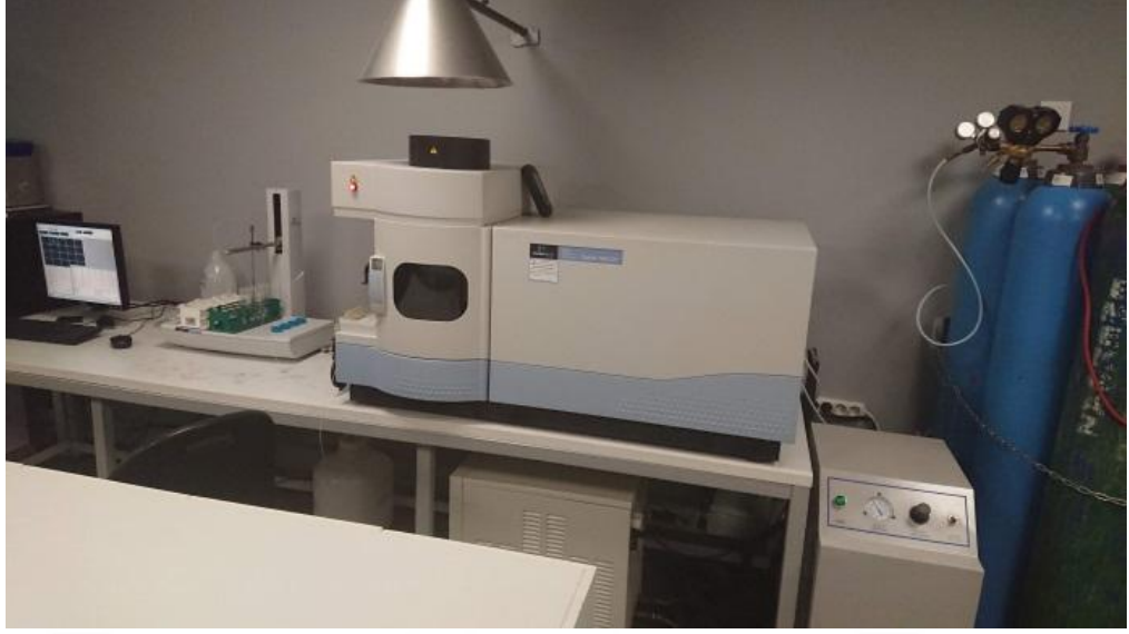
Şekil 3.6. Hazır hale getirilmiş numunelerin element analizi (ICP-OES “PerkinElmer - Optima 7000DV”)
